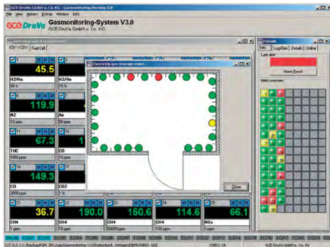
GasCom屏幕图解显示带报警功能的气瓶压力和低压显示
